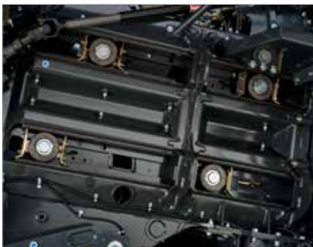
2. Rodillos del pistón de alta resistencia engrasados
