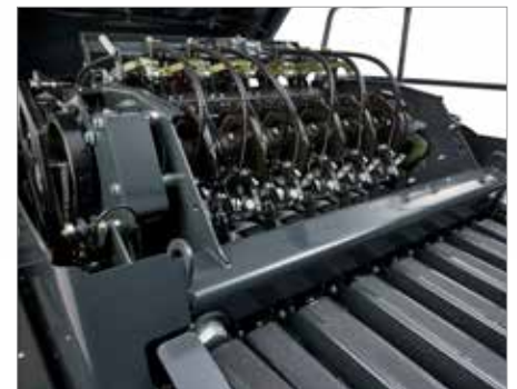
4. Sistema de atado doble con supervisión electrónica de serie
