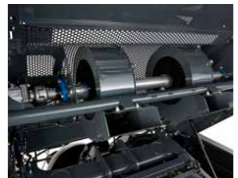
6. Turbinas de limpieza de la zona de atado
