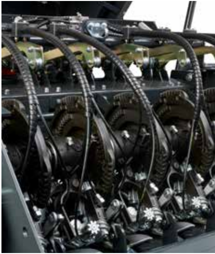
1. Sistema de atado doble con supervisión electrónica de serie
