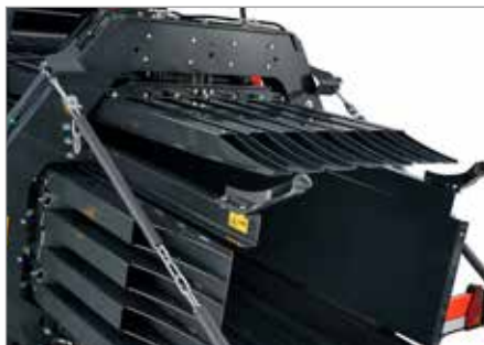
7. Longitud de 375 cm del canal de formación de las pacas
