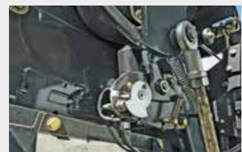
Sistema de atado eléctrico
