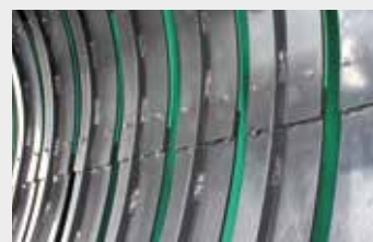
Placas de circulación fácil (Easy flow) para la cámara de precompresión
