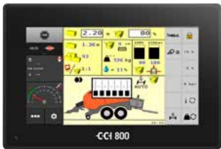
CCI 800: El terminal ISOBUS compacto La pantalla de 8 pulgadas/20,3 cm permite visualizar la máquina principal y vistas en miniatura en el lateral. Haz clic en la vista en miniatura para mostrarla en grande.
