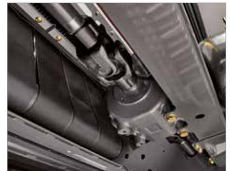
**7.** Juntas tipo cruceta cardán de alta resistencia en los ejes motores
