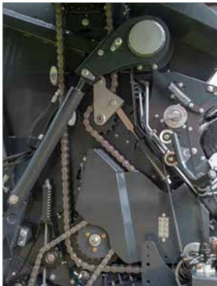
**10.** Transmisión robusta con cadenas resistentes al desgaste y de grandes dimensiones
