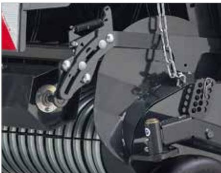
**4.** Dientes retenedores de forraje con resortes y rodillo altamente resistente (Ø 217 mm) para una mejor precompresión y flujo del forraje
