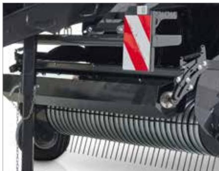
5. Dientes retenedores de forraje con resortes y rodillo altamente resistente (Ø 217 mm) para una mejor precompresión y flujo del forraje
