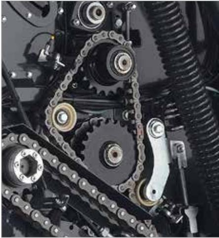
1. El segundo rodillo impulsor garantiza una propulsión de las correas en todo tipo de condiciones de forraje
