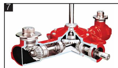
Caja de cambios integrada, engranajes bañados en aceite, accionan los discos y el eje de acero inoxidable agitados
