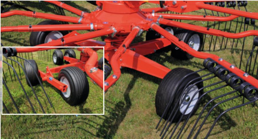
El eje bogie, que complementa al eje 3D (como equipamiento opcional) resulta ideal para guiar al rotor en condiciones difíciles (en presencia de marcas profundas de las ruedas, prados de pastoreo, etc.) y a una velocidad de avance elevada. En esos casos, se recomienda el GA 7501+.
