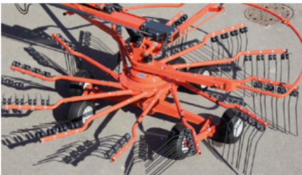
El eje bogie opcional debajo del rotor con 6 ruedas cerca de las horquillas garantiza un seguimiento del terreno optimizado.
