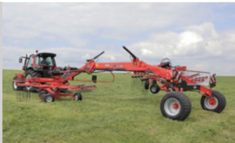
Monta una lona de hilerado en el rotor delantero para formar dos hileras
