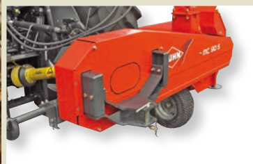
Enganche de remolque en posición baja. (MC 90 S y MC 90 S TWIN)
