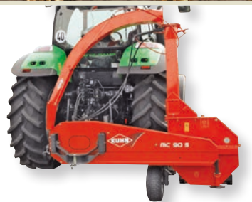
Canal plegable para almacenamiento y transporte. (MC 90 S y MC 90 S TWIN)
