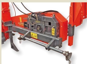
Ajuste lateral sencillo para la barra de enganche inferior. (MC 90 S y MC 90 S TWIN)
