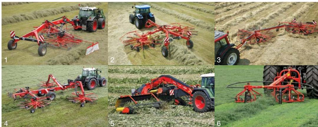
1. Rastrillos hileradores de doble rotor semisuspendidos de depósito lateral.
