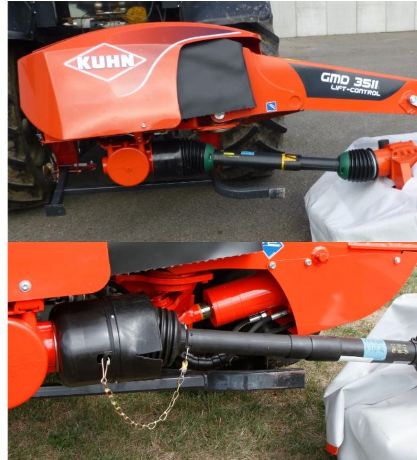
**El mantenimiento del eje de la T.D.F. es solo cada 100 horas**
