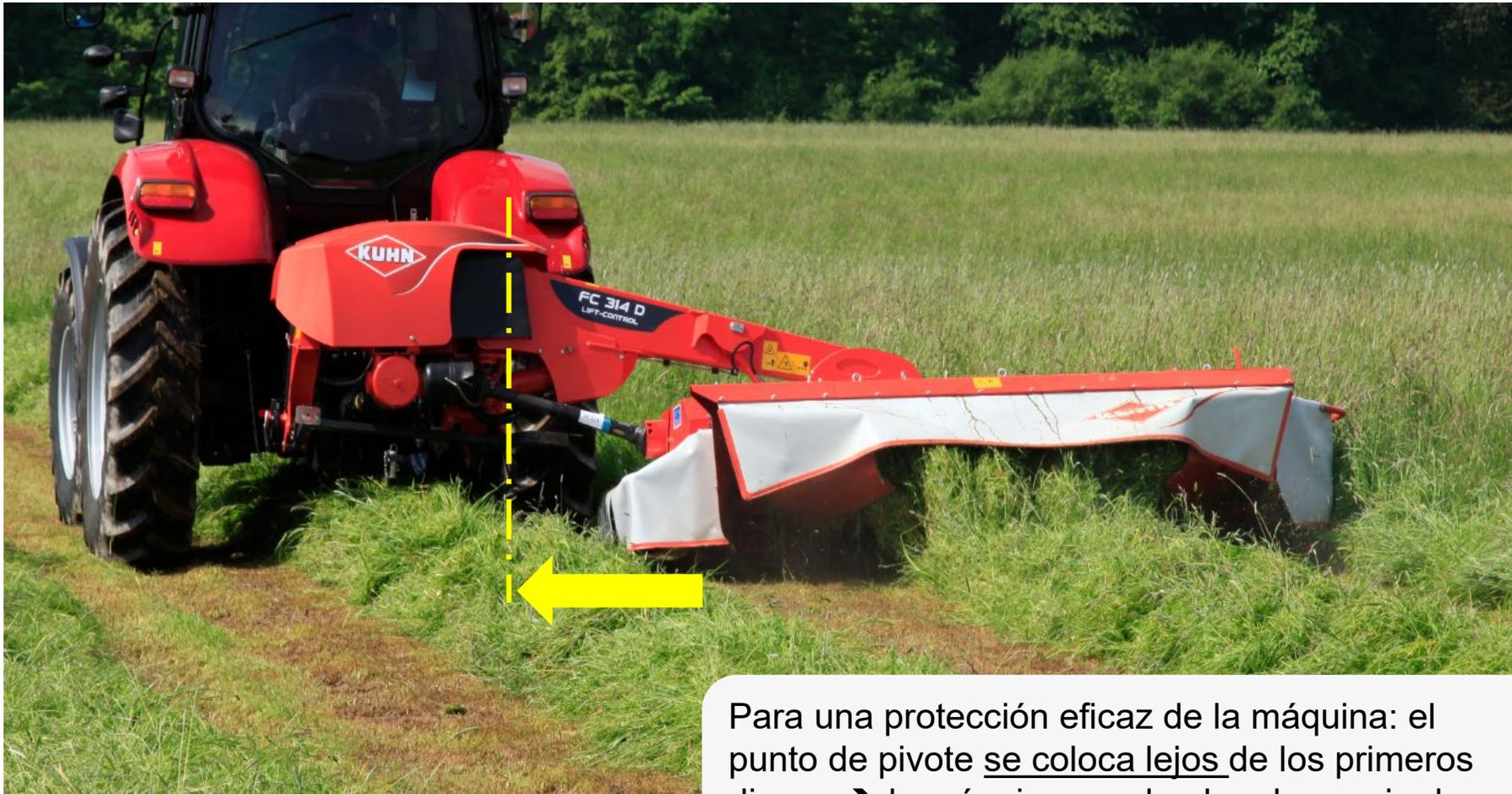
Para una protección eficaz de la máquina: el punto de pivote se coloca lejos de los primeros discos → la máquina puede absorber mejor los golpes
