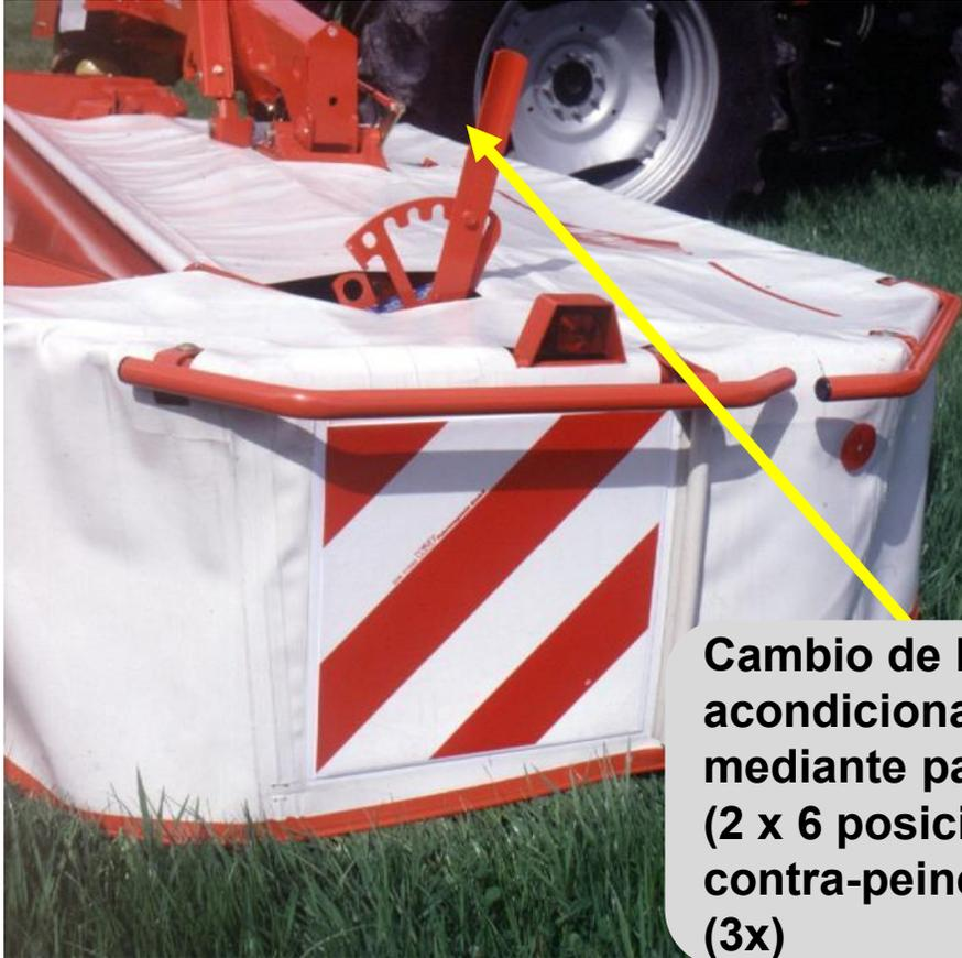
Cambio de la placa acondicionadora mediante palanca (2 x 6 posiciones) y contra-peine ajustable (3x)
