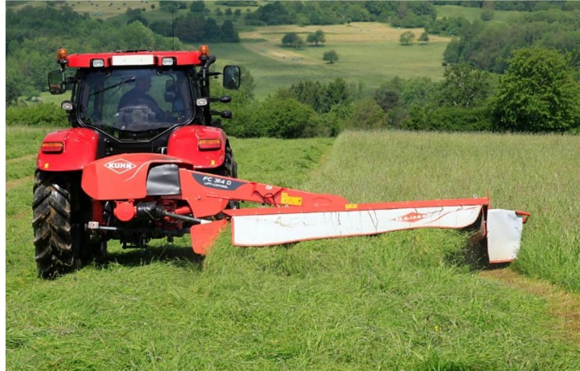
**Integra un cilindro de suspensión y de elevación en cabecera**
