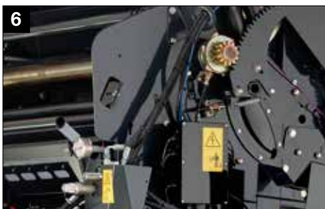
Válvula proporcional para control de densidad en el habitáculo
