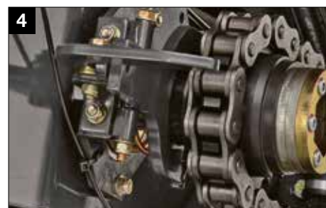
Desembrague mecánico del rotor
