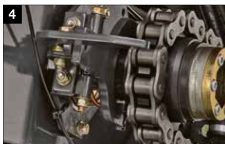
Desembrague mecánico del rotor
