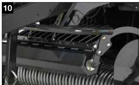
10 Rodillo cosechador de gran tamaño (Ø 217 mm)
